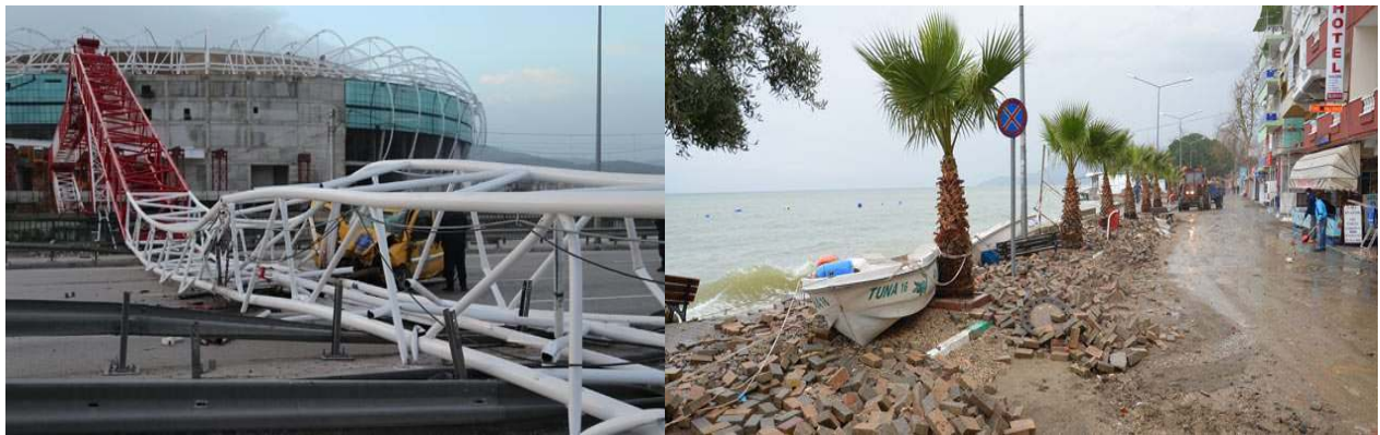
Şekil 2. (a) Bursa’da lodos’ta devrilen kule vincin görünümü [3] (b) Bursa’da Rüzgarda zarar gören sahil [4]
